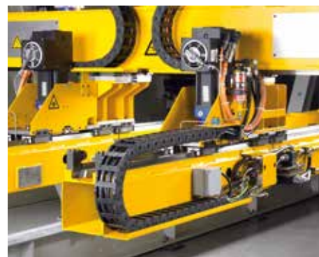
Sistema de transferencia de tres ejes con acoplamiento de barras de transferencia hidráulico (acoplamiento de barras de transferencia)
